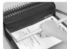
(Obr. 4) Pro úspěšné proděravění, kompletně stlačte madlo směrem dolů.
