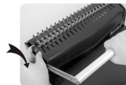
(Obr. 5) Vložte a otevřete kroužkový hřbet. Přepněte zámek hřbetu do otevřené pozice (OPEN).
