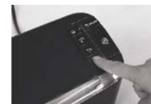
(Fig. 2) Stiskněte tlačítko, odpovídající použitému sáčku. Pro laminaci za studena, stiskněte tlačítko Studená.
